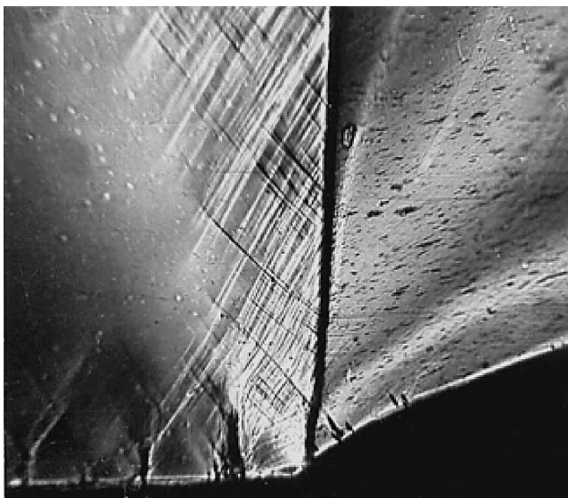
Рис. 13. Световая микрофотография образца ПЭТФ, деформированного при комнатной температуре с образованием шейки. Справа участок образца, перешедшего в шейку, слева – недеформированный участок образца. Фотография сделана в скрещенных поляридах.
