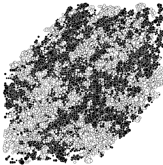
Рис. 1. Распределение энергии на узлах решетки размером 50 \times 50 \times 50 в дипольной полимерной матрице. Черные и белые сферы представляют узлы с положительными и отрицательными значениями энергии, радиус сферы пропорционален абсолютному значению энергии. Узлы с малыми абсолютными значениями энергии (меньшим 3ep/ea^2 , p — дипольный момент узла) не показаны для большей ясности изображения. Использованы типичные для дипольной полимерной матрицы значения p = 3 Д, a = 8 Å, \epsilon = 3 .
