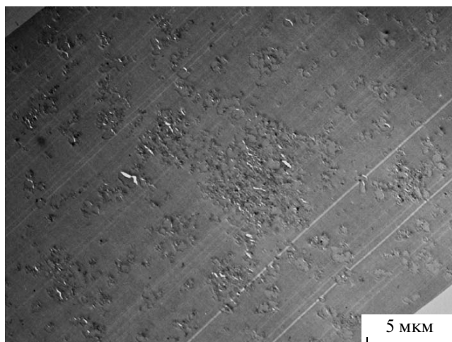
Рис. 2. Микрофотография среза композиционной пленки ПИ-СОД с 3% ПАНИ, полученная методом просвечивающей электронной микроскопии.
